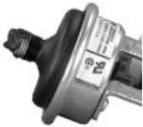
MELTED PRESSURE SWITCH
